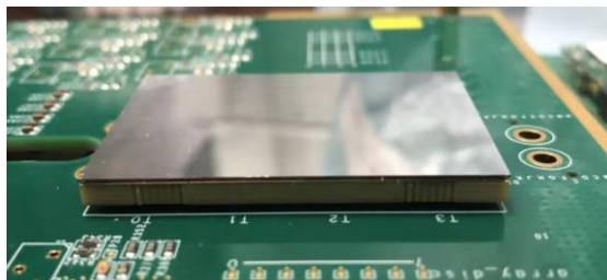
前端模块：传感器+ASIC+倒装焊
