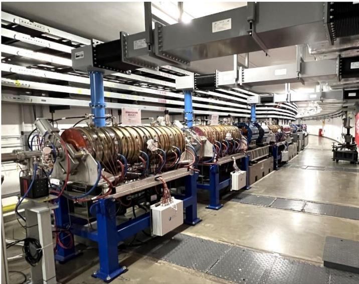
166MHz SRF cryomodule
