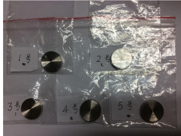
轭铁材料磁化曲线测量样品
