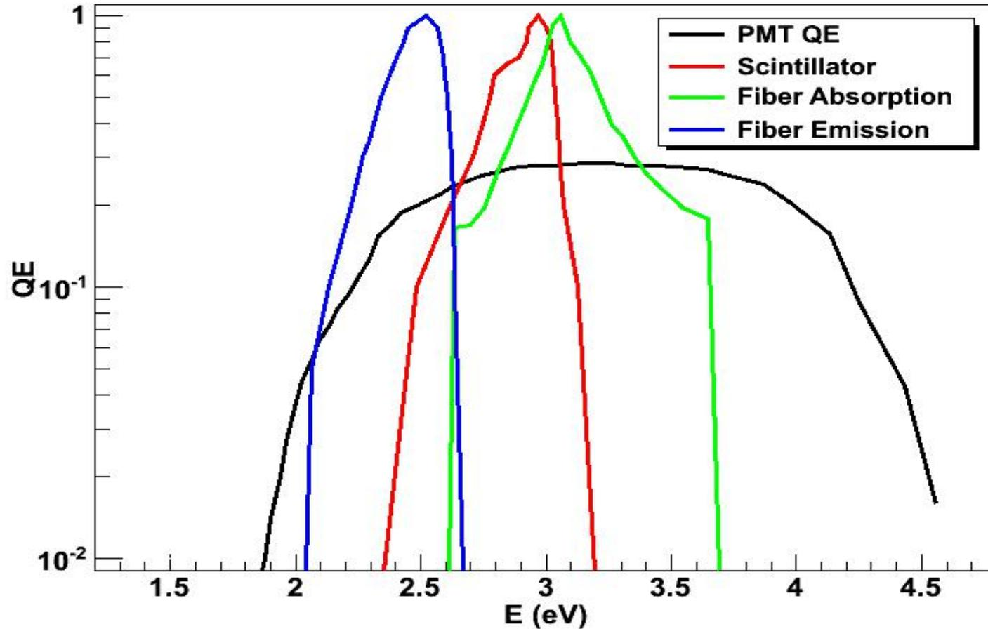
将PMT量子效率提前放进闪烁体和光纤中，减少追踪光子数。
