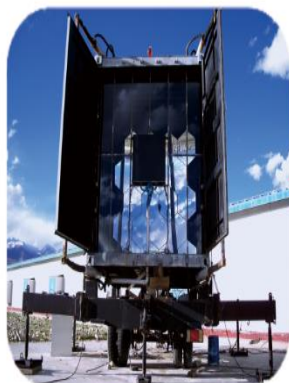
由24台广角成像望远镜组成的契仑柯夫光探测阵列
