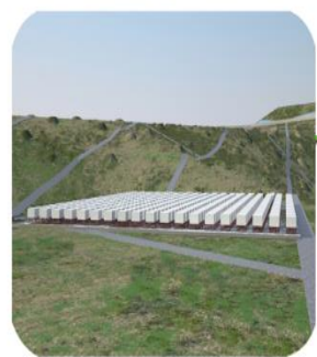
由22台闪烁体探测器组成的空气簇射探测器阵列
