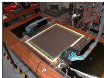
CAMPASS实验中的Micromegas探测器：上游径迹室 自2002一直在运行，效率>97%，空间分辨~70 \mu m
