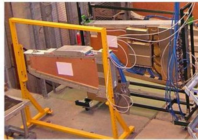
GE1/1探测器样机在进行束流测试。 Beam test of the GE1/1 prototype .
