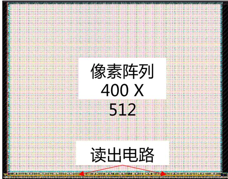
Topmetal M是基于国产华虹宏力130nm双阱先进CMOS工艺，由PLAC实验室自主研发的一款大面积阵列**Topmetal+MAPS**像素探测器芯片，具备高性能的**位置、时间、能量**分辨率。
