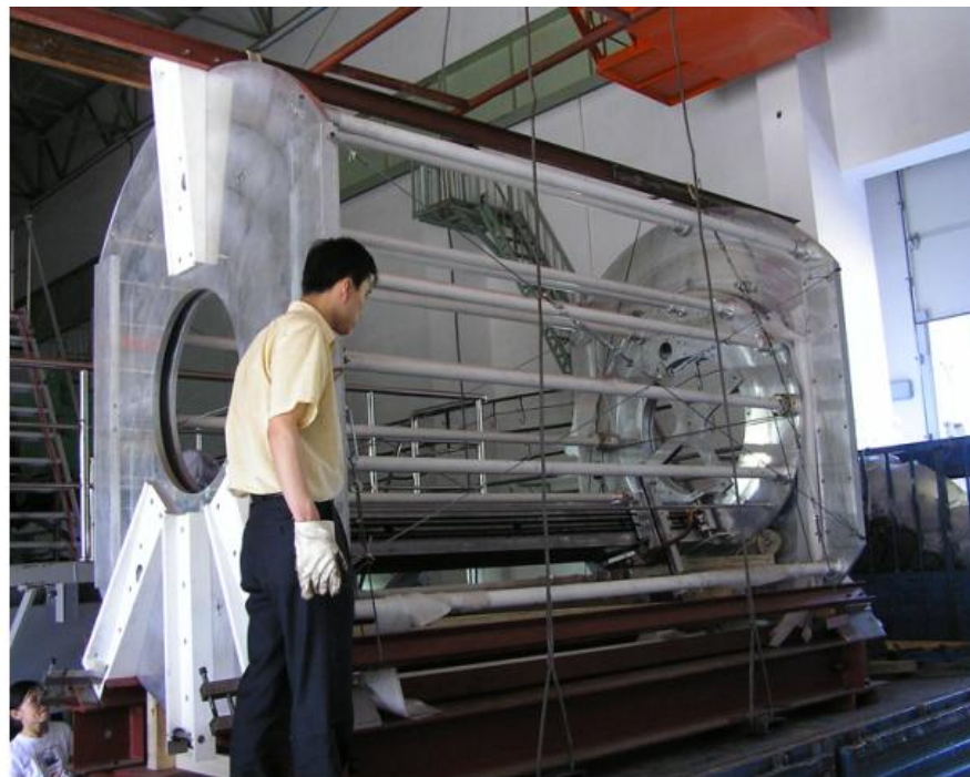
用于测定磁场分布的三维测磁机运抵我所
