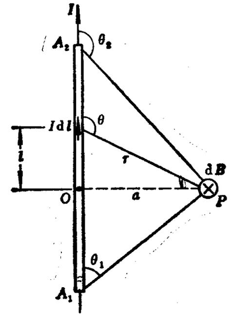
图 4-12 载流直导线的磁场
