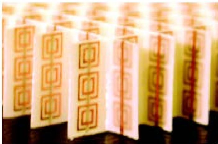
美国UCSD的NIM研究小组已经设计制成了具有负折射率的材料。这种材料是由铜质方形裂环振荡器和一条细铜线嵌在玻璃纤维的底板上形成的。铜质方形裂环振荡器（split ring resonator）和铜线分别嵌在底板的两面。（如图所示）。将用这样的材料制成的棱镜与用聚四氟乙烯（Teflon）制成的棱镜对比后发现，经两者折射的波偏离主轴的方向相反。由此证明了这种材料具有负折射率的性质。
