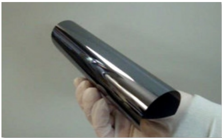
超薄CMOS传感器（<30微米），可卷曲且状态稳定
