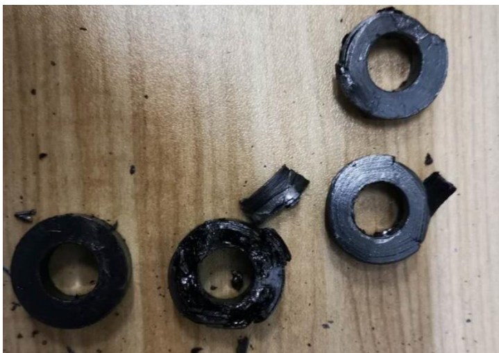
阀门失效填料更换
