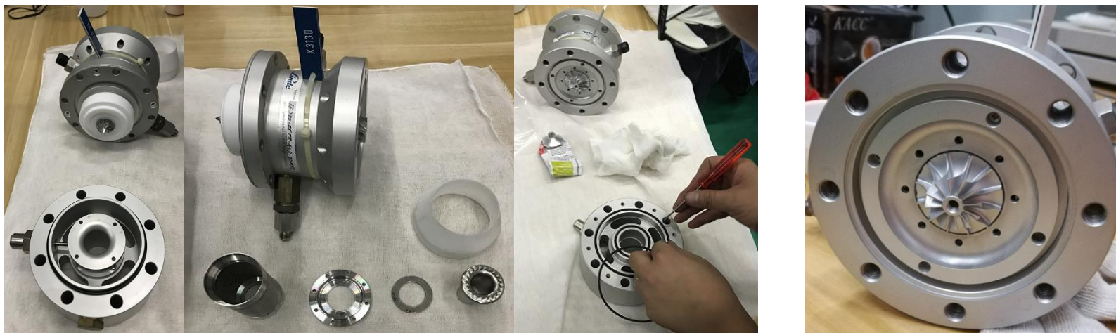
透平膨胀机拆装检查
