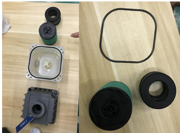
油雾分离器滤网更换
