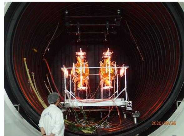
电子学舱热循环试验
