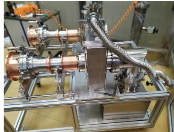
650MHz主耦合器 (400kW) 世界上最大的耦合器之一
