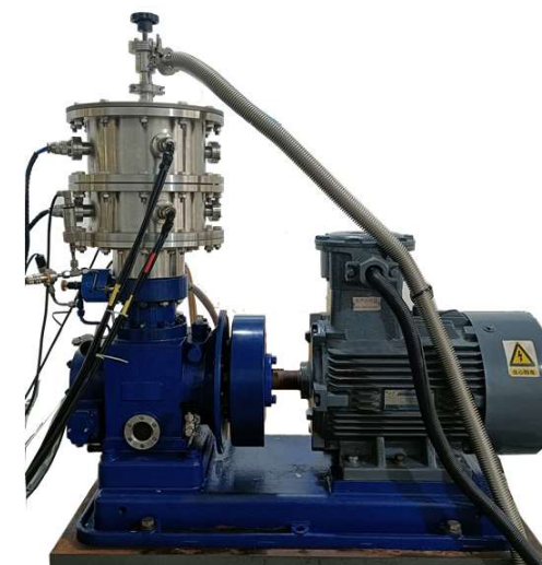
制冷量: 47.4 W @ 20 K, 138 W @ 30 K 单缸两级斯特林低温制冷机
