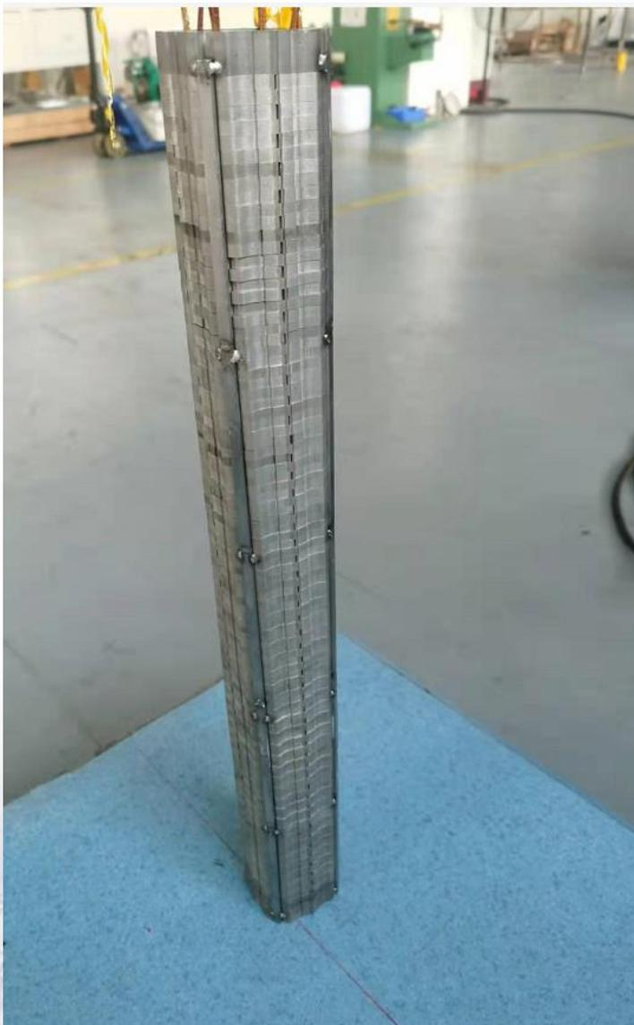
QD0-超导线圈卡箍的装配是短样机研制过程的核心工艺步骤，装配时需要确保线圈卡箍成型时被施加了许用应力，我公司目前正在摸索这个过程；
