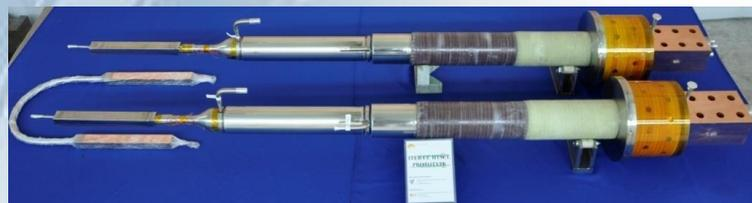
◆ ITER 10kA高温超导电流引线
