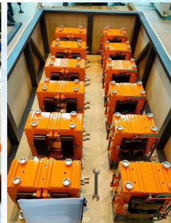
□ HEPS直线加速器和运输线的二极、四极和校正磁铁主要用于束流的偏转和能量分析、束流的聚焦以及轨道校正；
