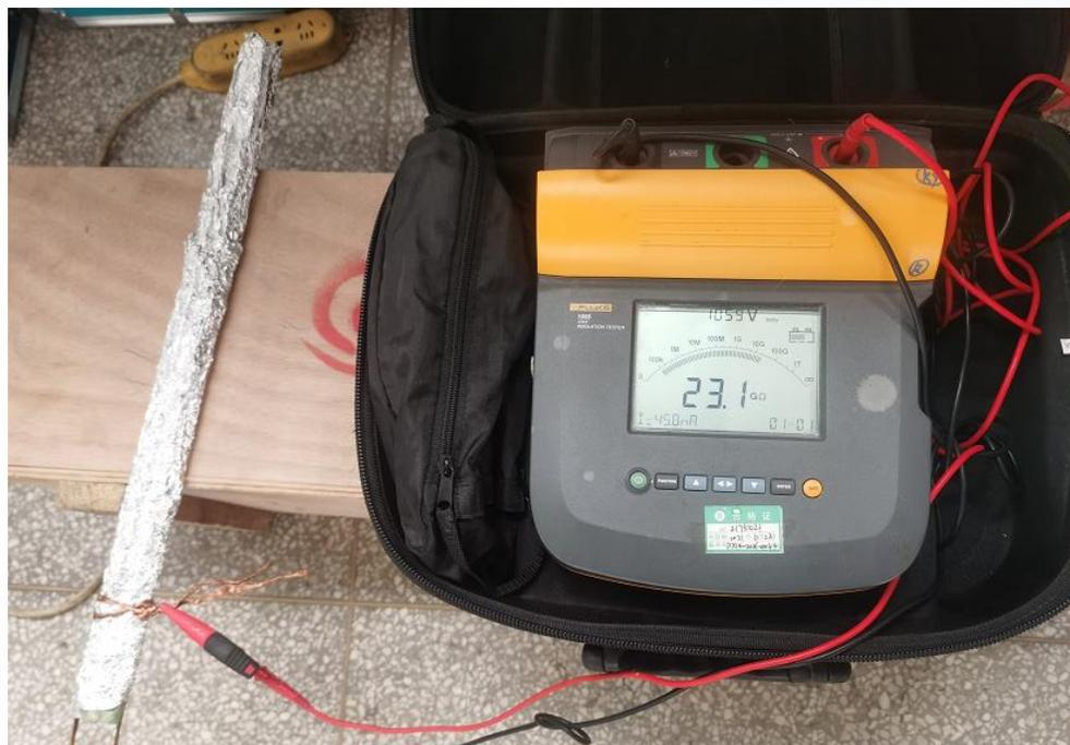
QD0超导四级线圈在绕制和固化完成后需要进行绝缘测试：
