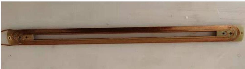
**QD0-超导线圈的目前研制的进展是已经完成了绕制及固化成型的过程，通过了1000V的对地绝缘测试；**
