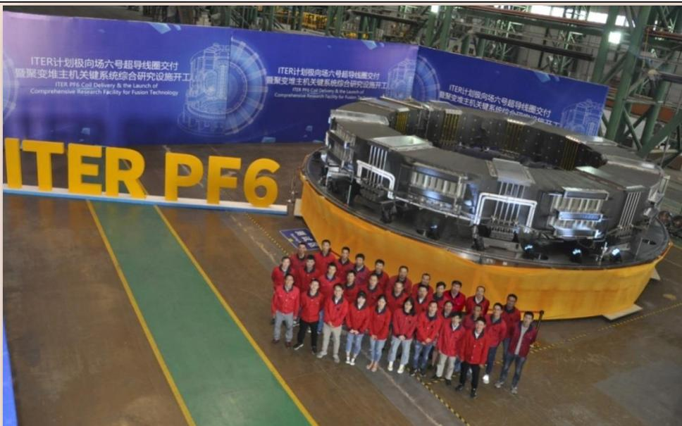
国际热核聚变实验堆（ITER）极向场6号线圈
