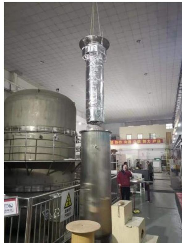
超导磁铁测试杜瓦
