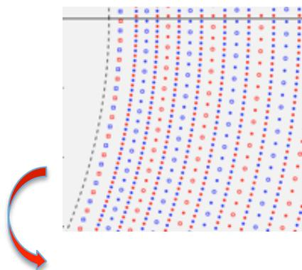
sense wires → 20  $\mu\text{m}$  diameter W(Au) ⇒ 56448 wires
