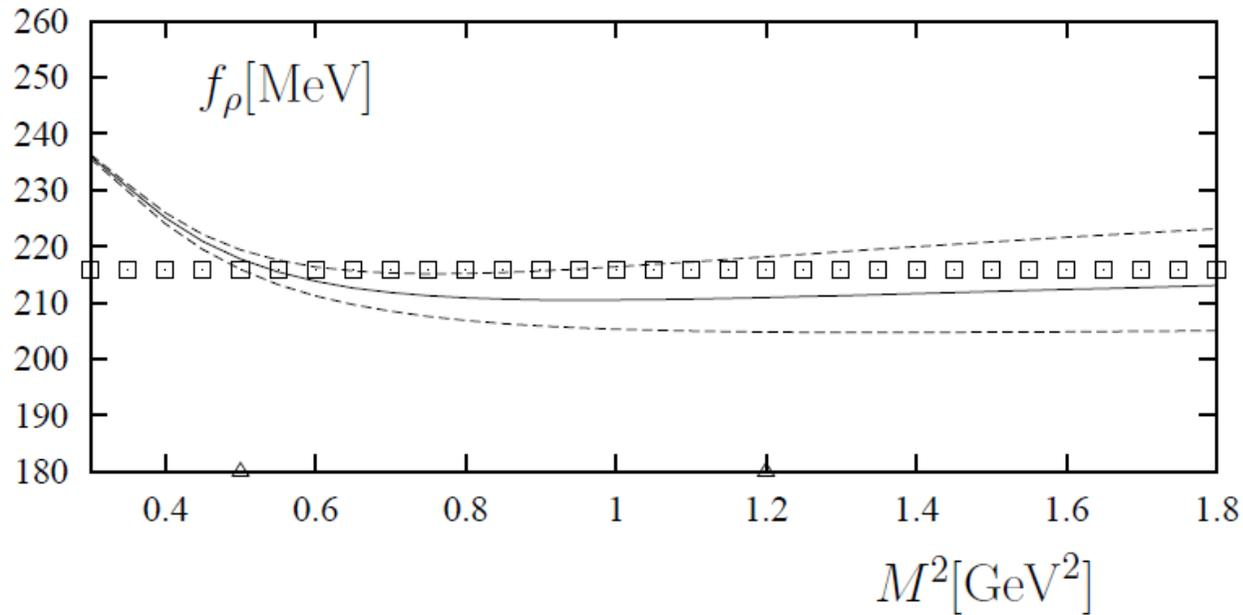
$\rho$ 介子衰变常数随Borel参数的变化曲线，实线是 $s_0^\rho = 1.7$  GeV<sup>2</sup>，上下方虚线分别为 $s_0^\rho = 1.5$ 和 $2.0$  GeV<sup>2</sup>的情况。方格线是实验测量中心值，横轴上的两个三角标志是Borel参数窗口上下限。
