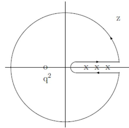
关联函数在复平面上的围道积分图, 图中 $q^2 < 0$ 点在QCD中可微扰计算,  $q^2 > 0$ 的正实轴上超过阈值会出现强子态的贡献, 表现为关联函数的奇点
