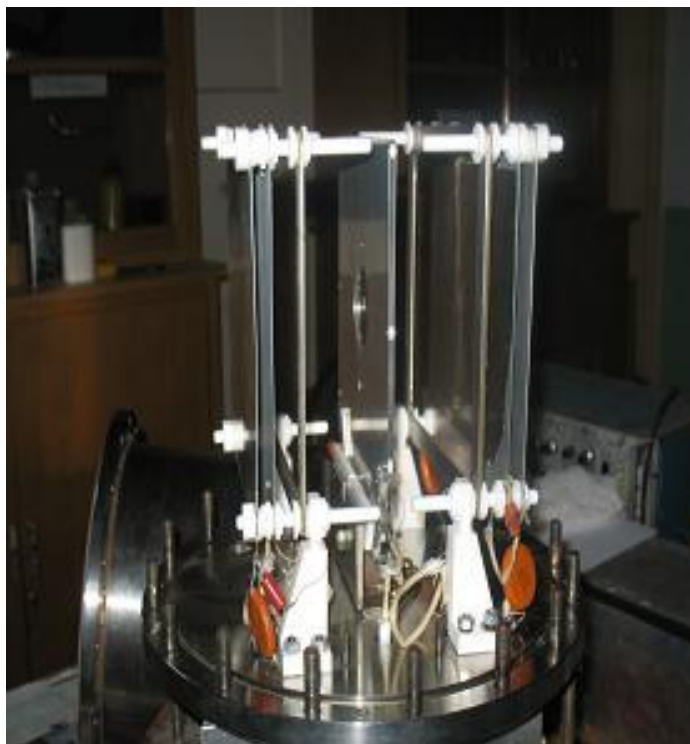
带样品转换器的屏栅电离室
