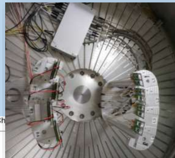
碳化硅探测器 ^{17}\text{O}(n, \alpha) 实验图
