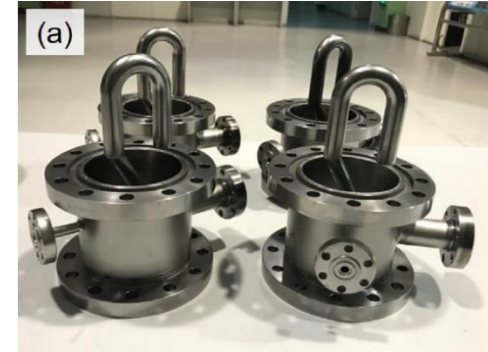
国内首个可拆卸大功率 高阶模耦合器 (1kW)
