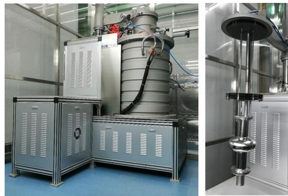
中科院高能所铌三锡超导腔蒸镀设备及1.3 GHz 1-cell铌三锡腔垂测初步结果
