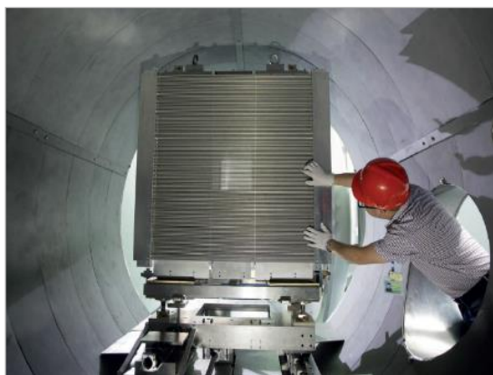
低真空下小角谱仪探测器系统
