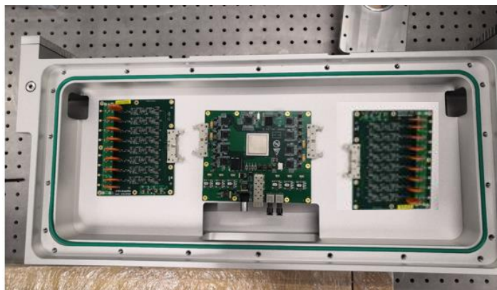
真空下密封单元模块加工
