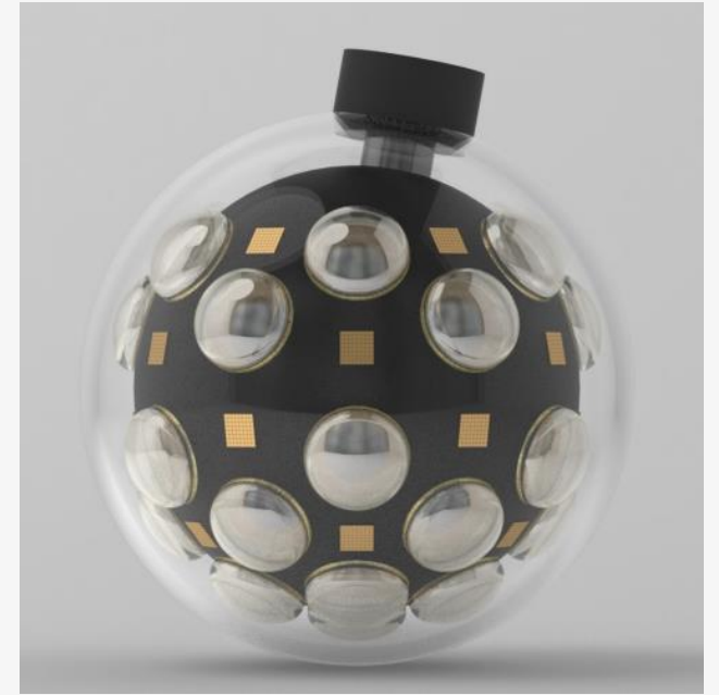
搭载PMT和SiPM的数字光学模组
