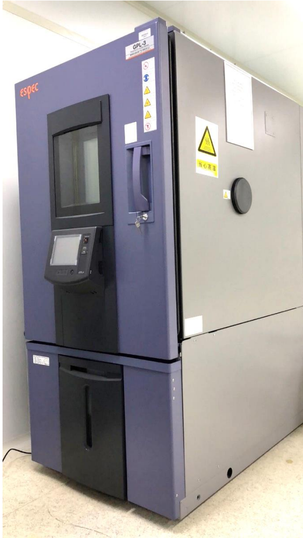
ESPEC 环境箱 ~16万，用于电子学元器件的老炼测试
