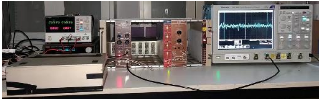
高能所肖特基二极管测试系统
