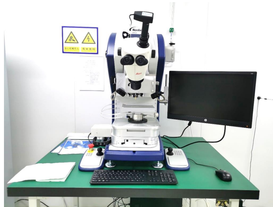
DAGE 拉力测试仪 ~50万，用于引线强度测试，以调整打线机参数和QA测试
