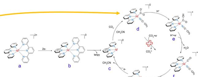
TR-XAS实验结合DFT计算表明催化剂得到光敏剂提供的电子后, 脱掉一半配体并吸附一个CO<sub>2</sub>分子, 实现CO<sub>2</sub>还原为CO的催化过程
