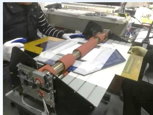
热压接技术制备Micromegas探测器
