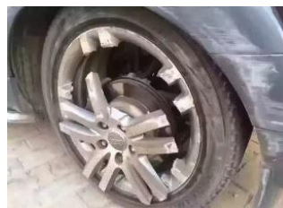
轮毂运行断裂
