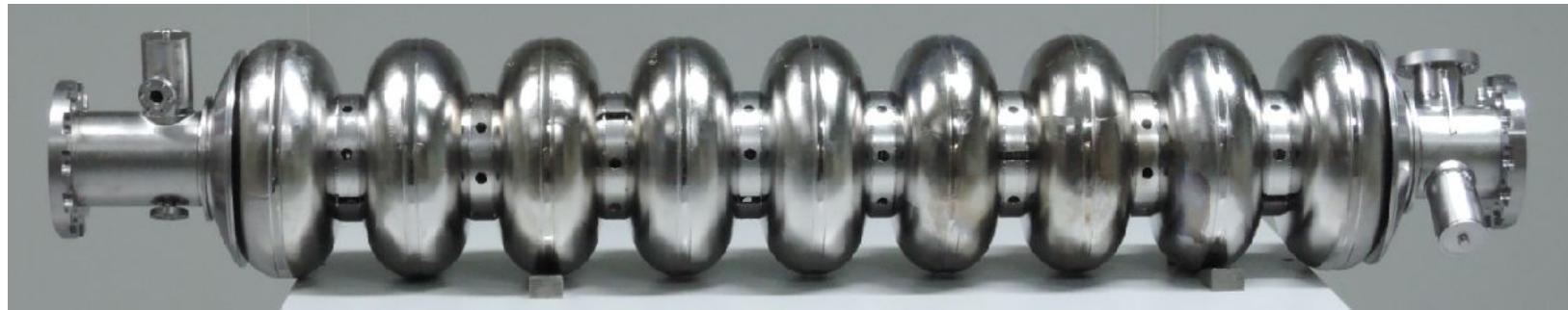
ILC型大晶粒1.3GHz 9 cell超导体腔(用于SHINE)
