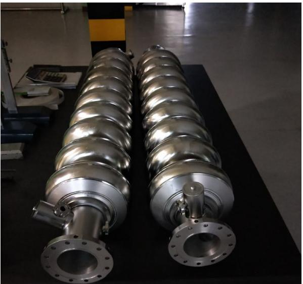
大晶粒Nb盘和腔的制造
