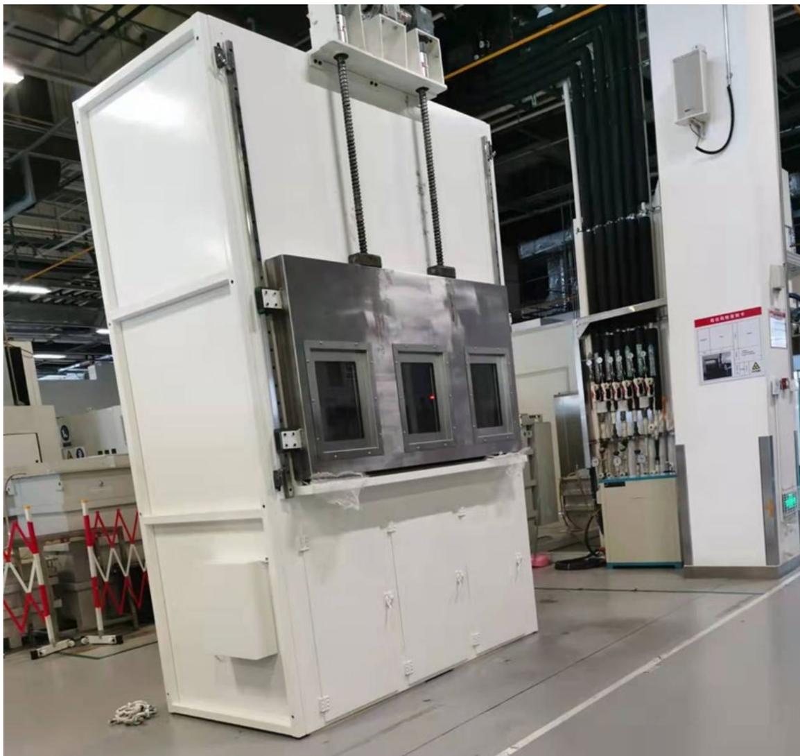
测试球管产生的X射线被白色设备包围，并限制在一定区域内
