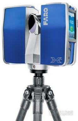
**激光扫描**是一种从复杂实体或实景中重建目标合景三维数据及模型的技术，具有速度快、高密度、高效率、成本低的特点。
