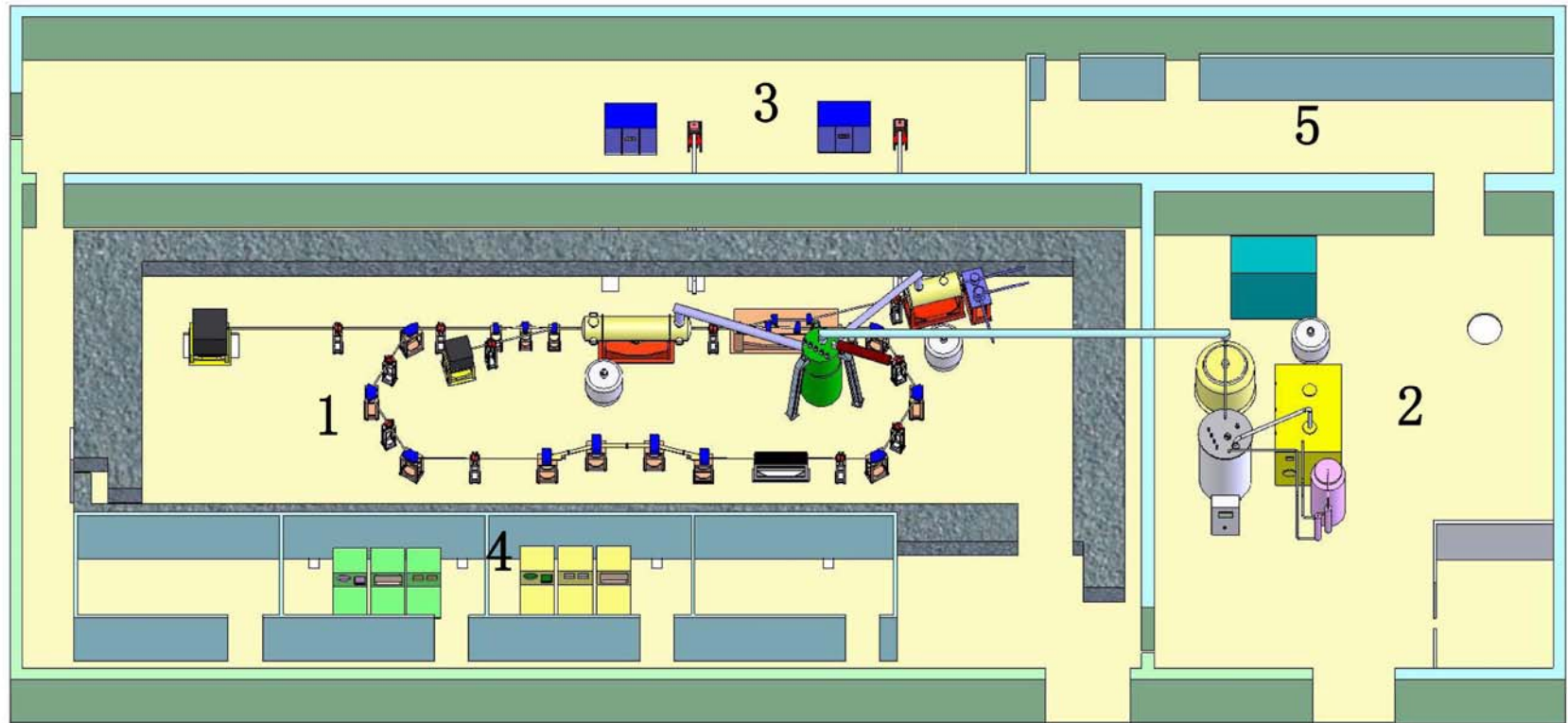
1. PKU-ERL-FEL装置 2. 低温液氦系统 3. 功率源 4. 控制室 5. 超净室及垂直测试平台
