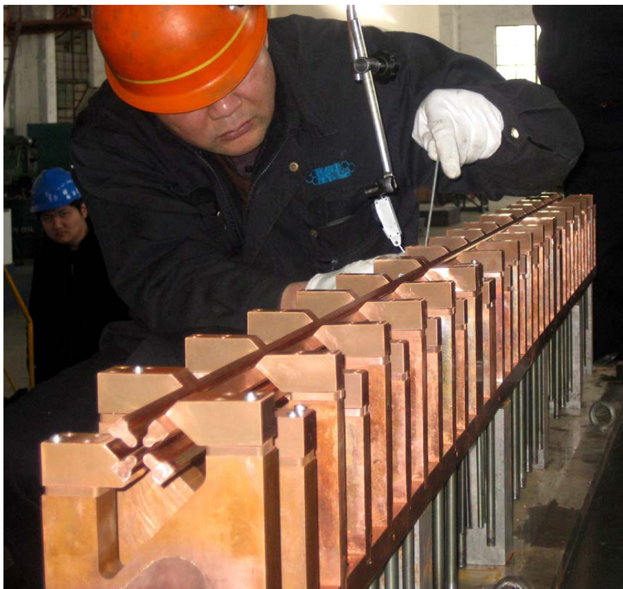
组装中的加速器电极结构
