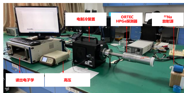
PXIe平台读出电子学与探测器联调
