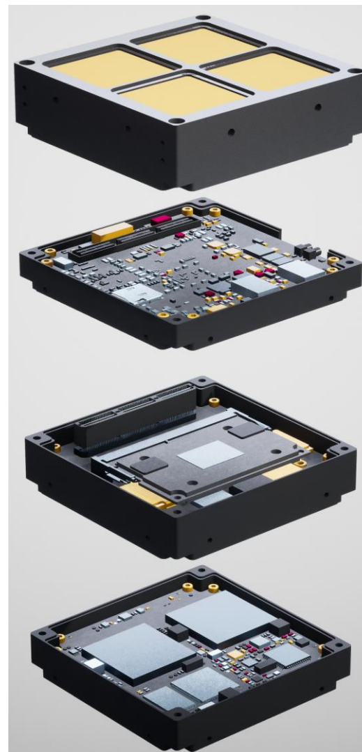
天格05B载荷架构图
