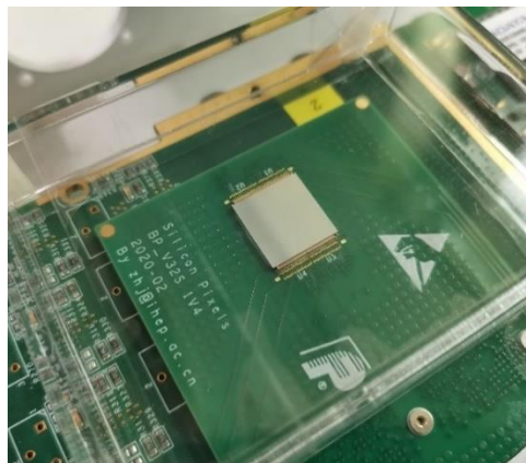
封装后的前端探测模块 灵敏 1\text{cm} \times 1\text{cm}
