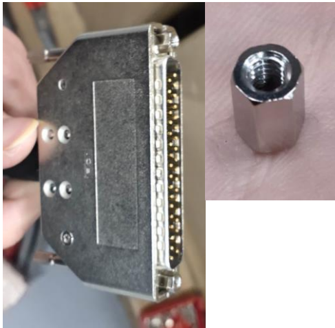
HV cable接头和螺母
