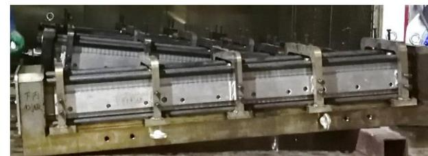
(3) 整铁芯固化时二次预紧，控制铁芯长度根据多次固化实验确定工艺参数
