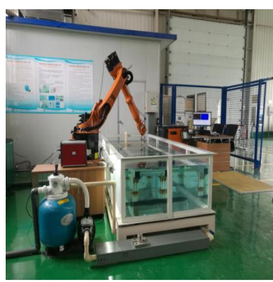
六轴机械臂自动化相控 阵水浸检测系统
