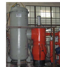
☆φ500长1000mm真空钎焊炉
