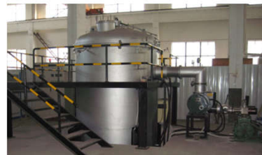
☆φ1600长2500mm真空氢气两用钎焊炉
