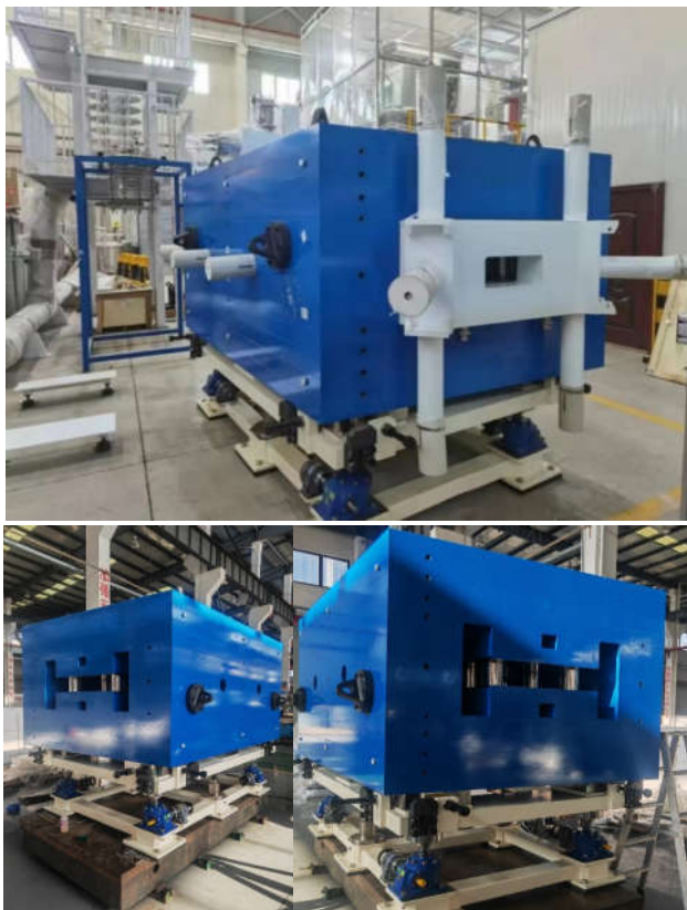
HIAF放射性次级束流分离器关键组件之一大型超导二极磁体铁芯
