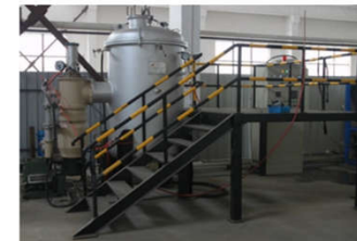
☆φ750长3000mm真空氢气两用钎焊炉
