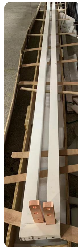
主线圈喷涂陶瓷涂层后
