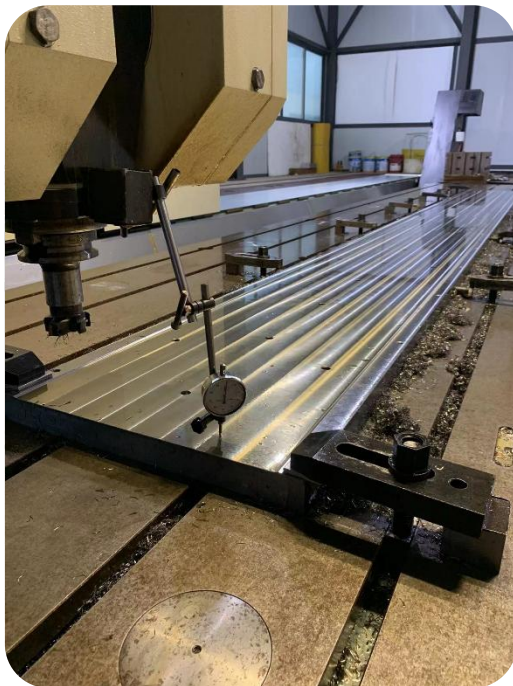
铁芯平面度检测
