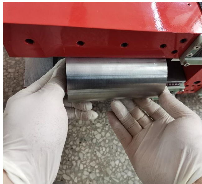
铁芯气息止规检测
