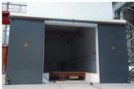
工业X射线探伤防护门，河南（2011），大型
