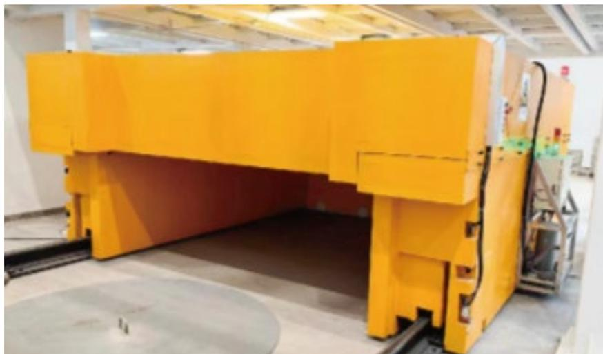
大型隧道孔射线防护门（榫卯联合）上海（2022）
