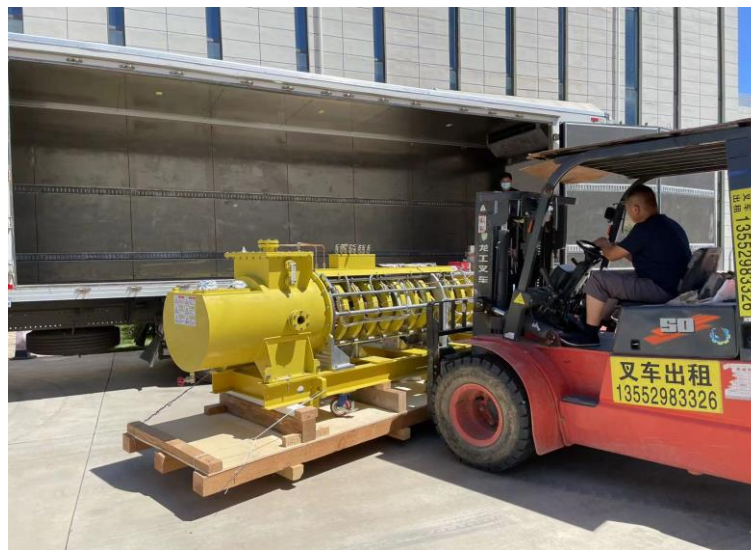
第一时间接收从高能所返回的高效率管并做妥善的安置，主要方向是保护管芯其他部件及阴极，同时做好问题部件的解剖分析
