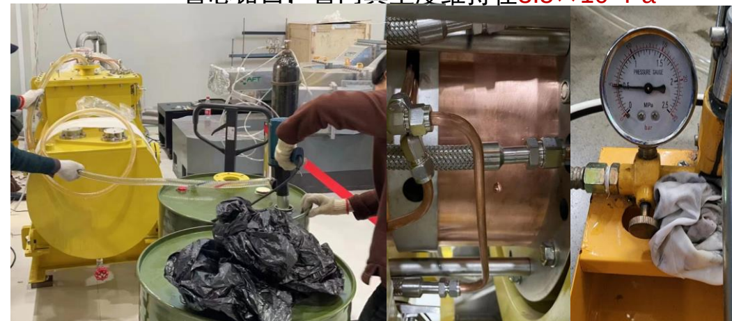
油缸注油检测、水压检测等
