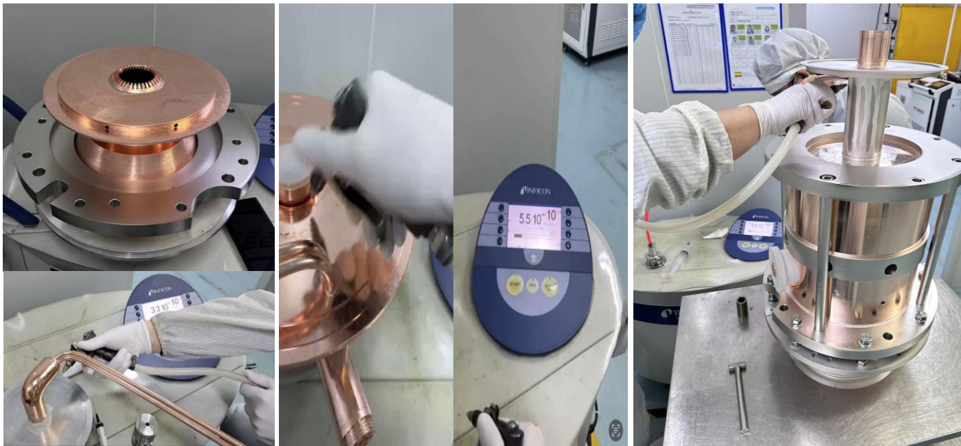
6-7腔大组件零部件加工制造与焊接检漏
