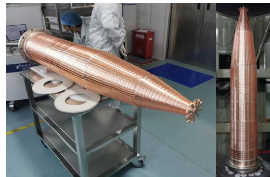
改进收集极表面结构，提高其冷却效率
