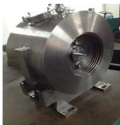
Spoke 012 ADS 注入器超导腔 小批量生产
