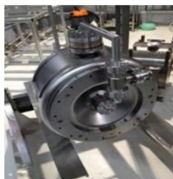
Spoke 024 第一支超导腔 (325MHz)
