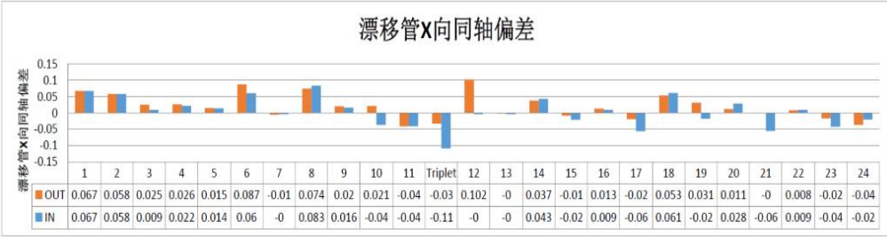
漂移管X向同轴偏差 (激光跟踪仪检测)
