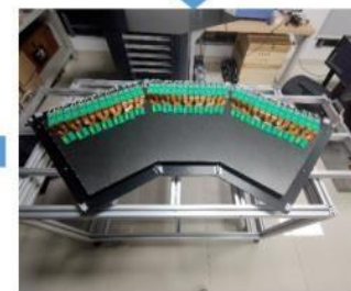
安装柔性读出板
