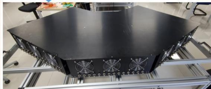
探测器安装完毕
