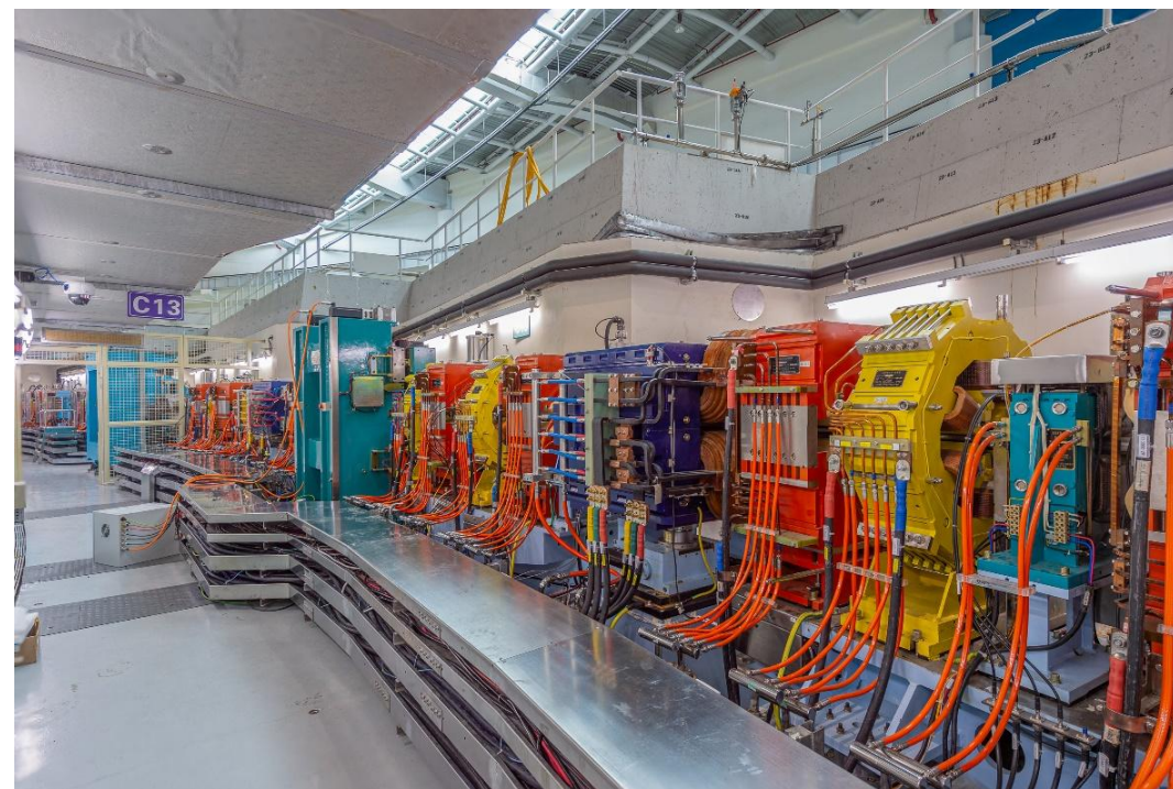
超高磁场弯铁的DBA磁聚焦结构单元实景照片
