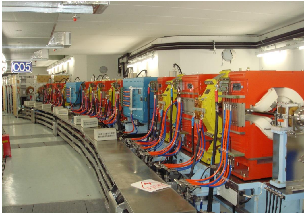
常规磁场弯铁的DBA磁聚焦结构单元实景照片
