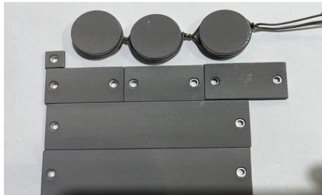
火焰喷涂Cd退耦合层，界面结合强度达到20MPa
