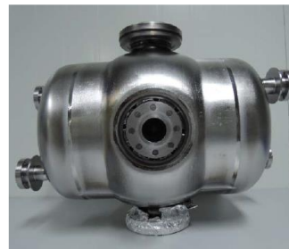
325 MHz HWR cavity (beta 0.14)
